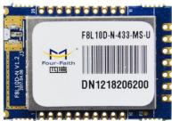
F8L10D LoRa 模块是一种基于 LoRa 扩频技术的嵌入式无线数据传输模块,支持四信私有协议、LoRaWAN、CLAA、LinkWAN等协议,同时利用 LoRa 网络为用户提供无线数据传输功能。
